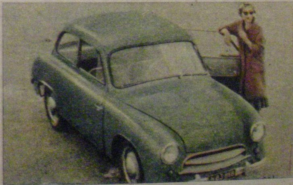
FSO - SYRENA: moc silnika 27 KM, szybkość maksymalna 98,4 km/godz., zużycie paliwa 6,8—7,4 l/100 km. Ciężar w stanie suchym 921 kg. Dopuszczalne obciążenie samochodu około 500 kg. Cena 72 tys. zł.
